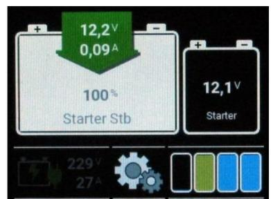
Im rechten Bereich des Batterie-Bildschirms erscheinen bis zu zwei Batterie-Spannungen der Zusatz-Batterien. Die Namen und zugehörigen Spannungs-Alarmschwellen können in den Einstellungen angepasst werden.
