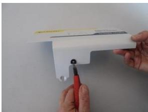
Einsetzen der Gummi-Kabeltülle
