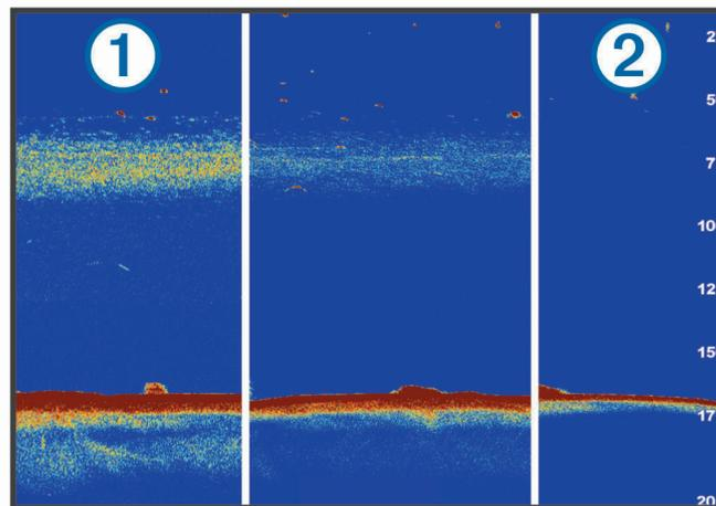
Sie können die Echodehnung auch zusammen mit der Filterbreite einsetzen, um eine bevorzugte Auflösung und Störungsreduzierung zu erzielen. Wenn Echodehnung und Filterbreite niedrig eingestellt sind, ist die Auflösung des Displays zwar am höchsten, allerdings ist es auch besonders störungsanfällig. Wenn die Echodehnung hoch und die Filterbreite niedrig eingestellt sind, ist die Auflösung des Displays zwar gering,
