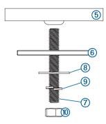
**9** Ziehen Sie die Muttern mit einem Drehmomentschlüssel an. Das Drehmoment sollte 13,7 bis 18,6 Nm (10 bis 14 lbf-in) betragen.
