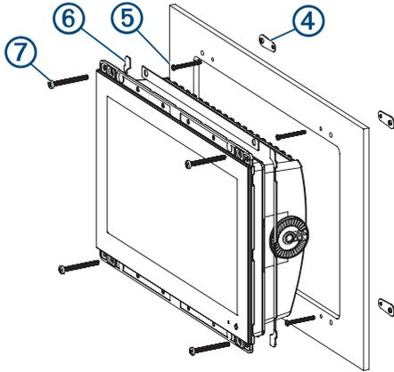
**16** Befestigen Sie die Anniemutter an der Montagefläche, indem Sie eine der mitgelieferten M3-Schrauben **⑤** in das kleinere 3,6-mm-Loch (<sup>9</sup>/<sub>64</sub> Zoll) einschrauben.
