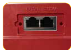
• Terminal Kommunikation Schnittstelle
